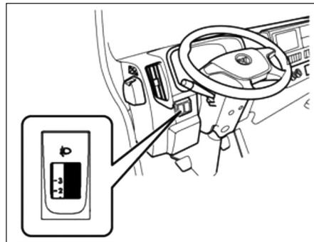
A altura do fecho do farol pode ser alterada para se ajustar ao peso da carga transportada.
