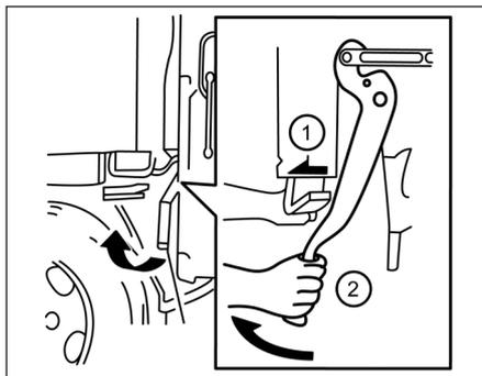
3. Segure a alavanca auxiliar ④ enquanto puxa a alavanca de segurança ③ para prevenir a subida repentina da cabine.
