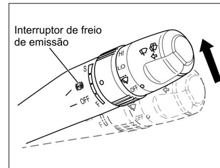
Para acionar o freio motor, puxe a alavanca do interruptor do limpador na direção do condutor e libere os pedais do acelerador e da embreagem.
