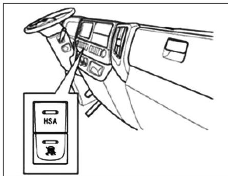
O interruptor de dupla função HSA e ESC permite a ativação simultânea de ambas as funções.
