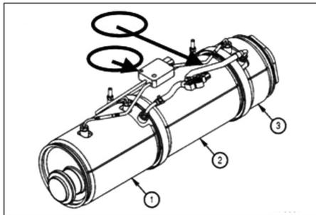
1. Catalisador de oxidação a diesel (DOC) - converte hidrocarbonetos (HC) e o monóxido de carbono (CO) e aumenta a temperatura de exaustão para atender aos requisitos de regeneração do DPF.
