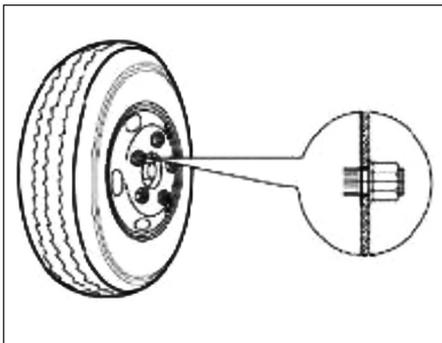
3. Use a chave de roda para apertar todas as porcas das rodas na ordem mostrada. O torque de travamento pode ser encontrado na seção Guia de Manutenção do Capítulo de Manutenção e Manutenção.
