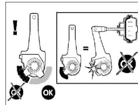
3. Use uma chave Allen de 12 mm e gire o braço no sentido horário, de modo que o orifício do braço de ajuste é naturalmente alinhado com o orifício de posicionamento do garfo em forma de U da câmara de ar.
