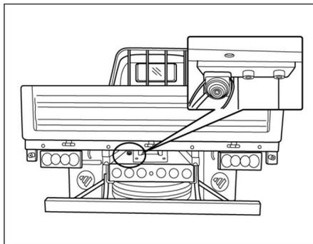
Ligue a ignição e engate a ré. O sistema de som/imagem será automaticamente ligado e exibindo a imagem da câmera de ré.
