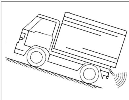
2. As ondas sonoras emitidas por rádios ou antenas de potência ultra alta podem causar interferência nos sinais dos sensores ultrassônicos.
