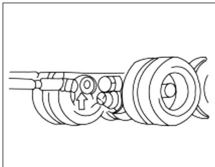
Caso a transmissão do veículo esteja danificada, remova o eixo de acionamento do flange do eixo traseiro e prenda sua extremidade ao chassi.
