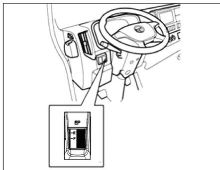
Em um modelo equipado com este comutador, a comutação da potência econômica do motor (E) (P) pode ser realizada para ajustar as duas engrenagens Econômica (E), Potência (P) do comutador.
