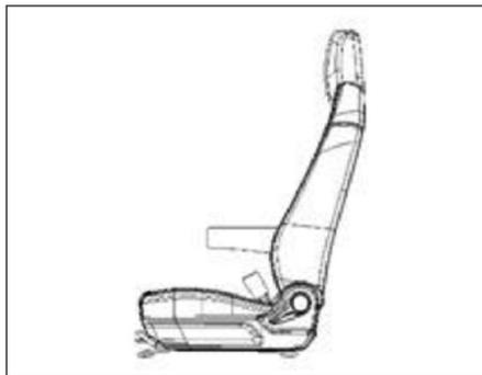
Puxe a alavanca de ajuste na frente do assento para cima para ajustar a posição do assento do motorista para trás e para a frente.
