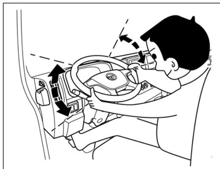
Além disso, balance o volante de direção em todas as direções para verificar a folga da instalação e quanto a afrouxamento.
