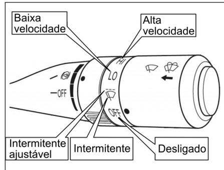
O interruptor do limpador do para-brisa possui quatro posições: desligado, intermitente, velocidade baixa e velocidade alta.
