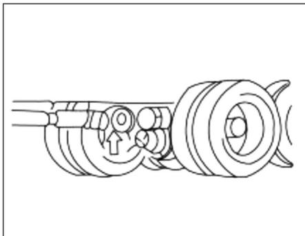
Se a pressão do ar for reduzida, a mola dianteira e traseira podem ser soltas manualmente. Solte o freio com a mão.
