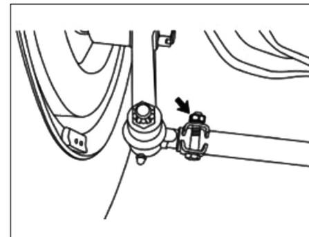
5. Gire a barra de direção para ajustar o comprimento da barra de direção e a convergência das rodas dianteiras para o valor especificado de 1 a 3 mm, e em seguida reaperte a braçadeira da junta esférica.
