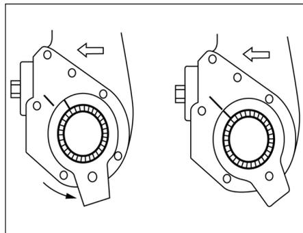
④ Em seguida, instale o suporte do braço de ajuste e, a seguir, prenda o braço de controle ao suporte de posicionamento.
