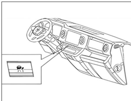
Nos modelos com esta configuração, a ativação e desativação das funções AEBS e ACC podem ser controladas por este comutador.
