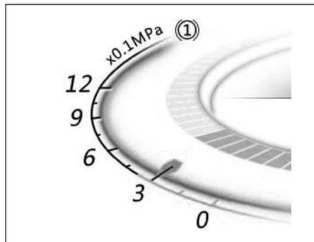
O alarme soara sempre que a pressão de qualquer dos eixos for inferior a 0,4 mPa (faixa vermelha).
