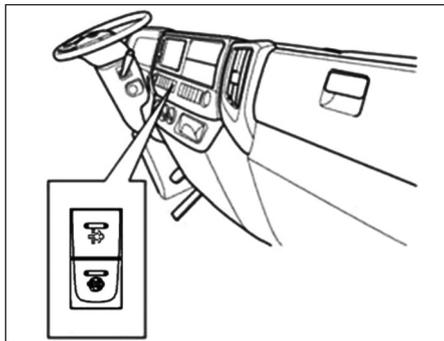
Esse interruptor, enquanto acionado, impede que ocorra regeneração do filtro DPF. Essa função não deve ser usada quando o veículo estiver sobre pastagens, próximo a produtos ou vapores inflamáveis ou em qualquer situação onde seja necessário evitar altas temperatura do sistema de exaustão.
