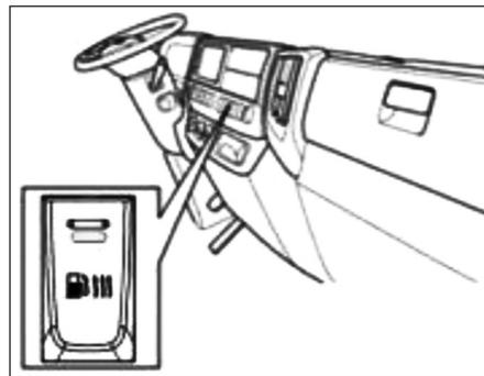
Este interruptor controla a válvula de corte da água de pré-aquecimento do combustível. Com este interruptor pressionado, o sistema de pré-aquecimento do combustível começa a aquecer o combustível no tanque principal.
