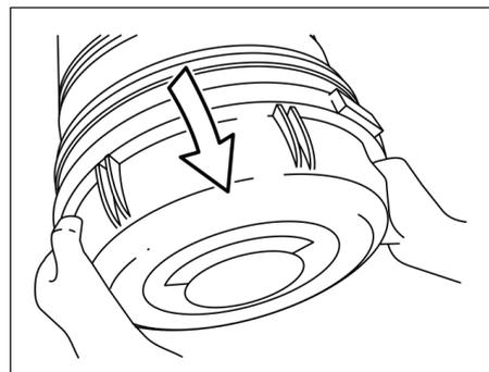
5. Pressione o filtro no revestimento superior do filtro de ar.
