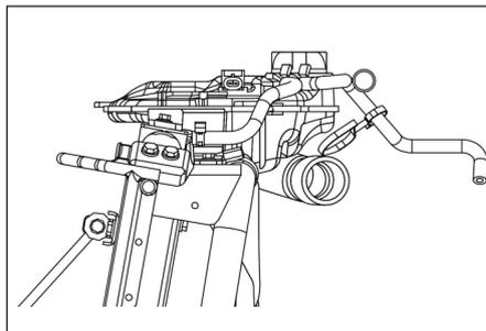
3. Ligue o motor e mantenha-o a 1.500 rpm por cerca de 3 a 5 minutos; observe o nível no tanque de expansão.
