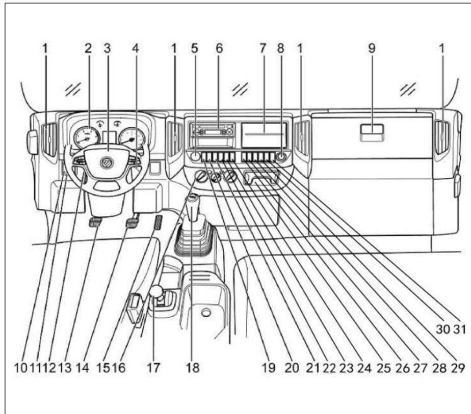
1. Grades de ventilação do painel de instrumentos
