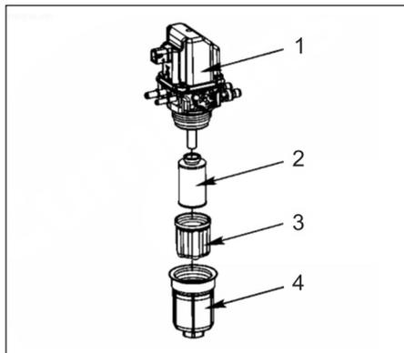
Desconecte a bateria para iniciar o procedimento. Em seguida, remova a carcaça do filtro de solução de ureia. Utilize uma chave de 46 mm para facilitar a remoção.
