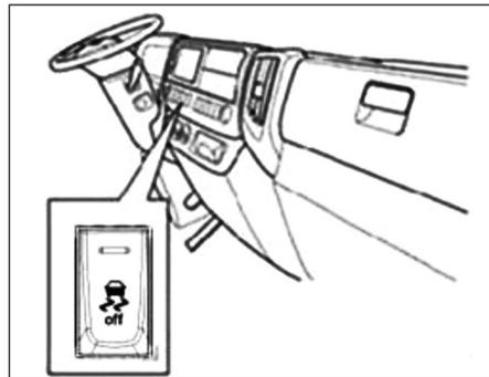
Caso o veículo fique preso na lama ou na neve, ou condição similar, a desativação da função ESC permite que a roda deslize ou recupere a aderência.
