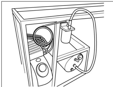
3. Retire o bocal de uréia do tubo de escape e coloque-o num recipiente limpo.
