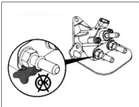
1. Verifique periodicamente se existem fugas ou cristais brancos na junta do bico injetor. Caso existam, repare a vedação o quanto antes.
