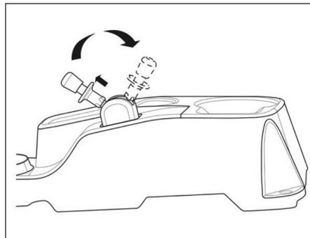
2. Remova a tampa de borracha do parafuso de sangria. Conecte uma extremidade de uma mangueira transparente ao parafuso de sangria e posicione a outra extremidade em um recipiente limpo.
