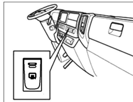
O aquecedor deve ser utilizado para remover as gotículas ou embaçamento no retrovisor causados pela condução sob chuva, nevoeiro ou neve.
