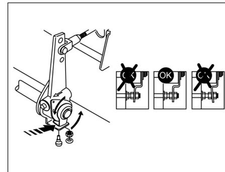
5. Ajuste as folgas: Com uma chave gire o fuso sentido horário até que a placa de fricção entre em contato com o tambor do freio. Em seguida, gire o fuso 3/4 de volta no sentido anti-horário (ocorrerá um “estalo”).
