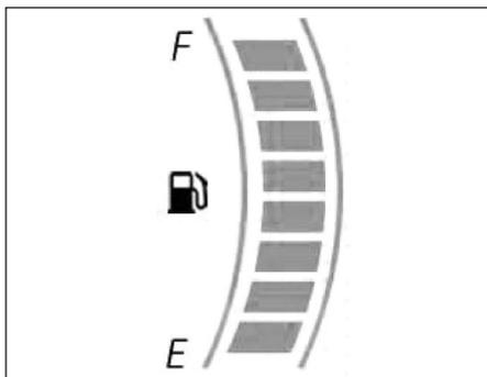
5. Verifique se o nível da solução de ureia mostrado pelo indicador é compatível com o nível real no tanque.
