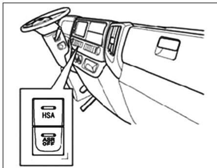
Caso o veículo fique preso na lama ou na neve, ou condição similar, o cancelamento da função ESC/ASR permite que a roda deslize ou recupere a aderência.
