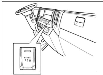
Para iniciar o uso da tomada de força, acione o interruptor uma vez. O motor assumirá a primeira rotação especificada. Podem existir até cinco rotações especificadas. Desligue o interruptor e acione-o novamente; o motor assume a segunda rotação especificada. Finalmente acione o interruptor mais uma vez e o motor retorna à marcha lenta.
