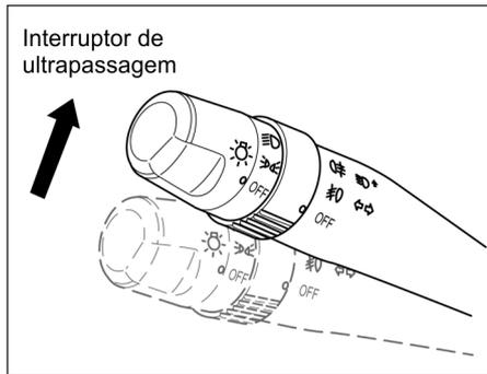
Quando o farol baixo estiver desligado, o farol alto funciona de forma intermitente, ou seja, ele apaga assim que a alavanca do interruptor é liberada.
