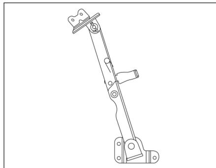
2. Segure o apoio de braço auxiliar ④ com a mão esquerda, empurre a trava ⑤ para frente para liberar o estado de travamento do suporte da cabine e puxe o suporte da cabine para trás, abaixando lentamente a cabine.
