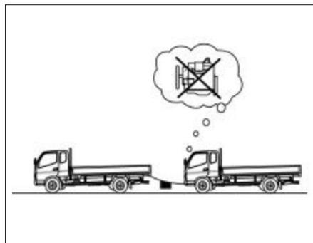
Em caso de partida com bateria auxiliar, utilize uma bateria com a mesma tensão nominal da bateria do veículo.
