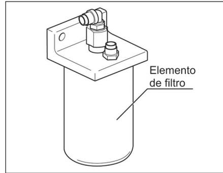
O filtro de ar de conexão em série (separador de ar e óleo) está localizado no tubo de fornecimento de ar da unidade de controle de injeção, que protege a unidade de controle de injeção do resíduo excessivo de óleo no sistema.
