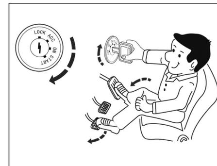
Assim que o motor pegar, libere a chave de ignição. Ela deve retornar automaticamente para a posição "ON" (ignição).
