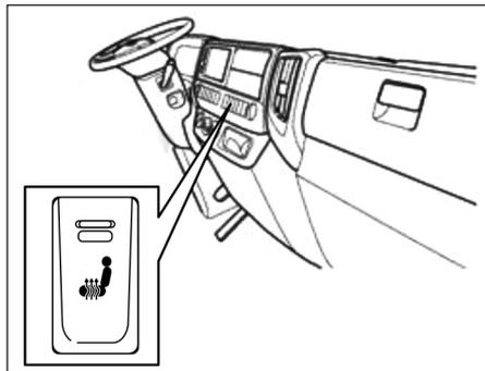
Este interruptor controla a função de aquecimento do assento lateral do motorista. Acione o interruptor e o assento do motorista começa a aquecer.
