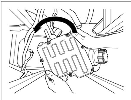
2. Levante lentamente a unidade de injeção e o sensor de nível de líquido para fora do tanque de uréia.
