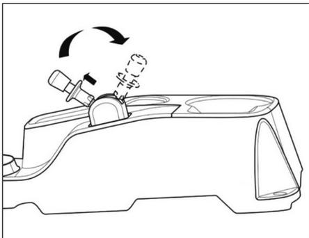
**Tipo de freio hidráulico:** puxe a alavanca de freio de estacionamento;
