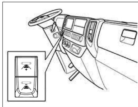
Nos veículos com essa configuração, o interruptor do controle de velocidade pode ser utilizado para selecionar a distância do veículo à frente na função ACC.
