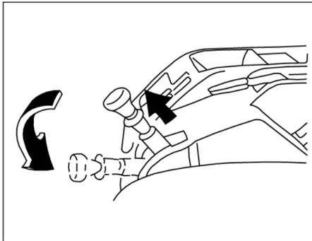
**Válvula manual do freio de estacionamento (tipo de freio a ar)**
